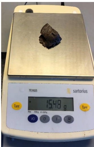
Figur 25 Vægten af vanddrukken træprøve før og efter ovntørring
