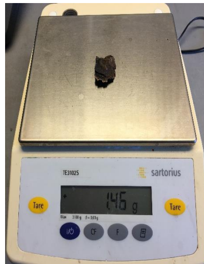
Figur 25 Vægten af vanddrukken træprøve før og efter ovntørring
