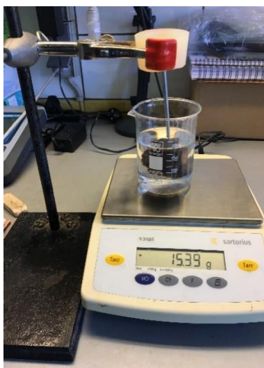
Figur 24 Vægten af vanddrukken træprøve i vand og efter ovntørring
