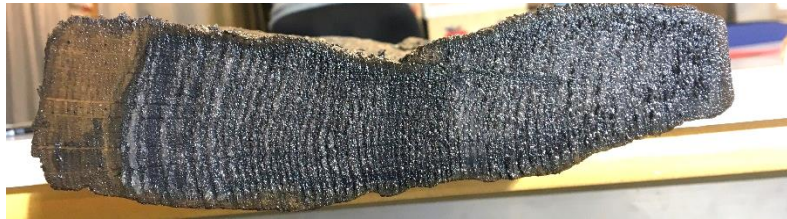
Figur 28 Tværsnit af egetræsbrøndplanke.
