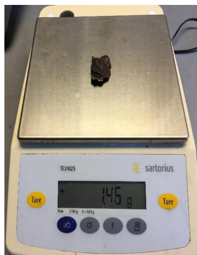
Figur 24 Vægten af vanddrukken træprøve i vand og efter ovntørring
