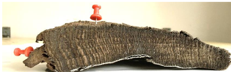
Figur 29 Tørret egetræsbrøndplanke. Splintveddet til venstre er skrumpet helt ind.
